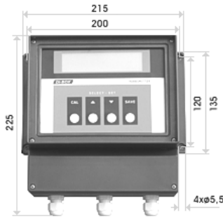
Rys. Wymiary przetwornika M1200 i rozstaw otworów pod śruby mocujące
