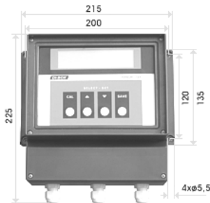
Rys. Wymiary przetwornika M1100pH i rozstaw otworów pod śruby mocujące
