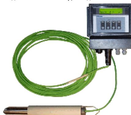
→ Зондирующая головка плотности осадка **MCM 433**
