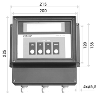
Rys. Wymiary przetwornika M1600 i rozstaw otworów pod śruby mocujące
